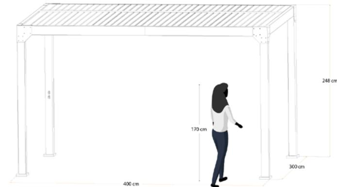
El modelo “Somerset 3x4” es una **pérgola bioclimática automatizada hecha con una aleación de aluminio resistente a la corrosión.**
