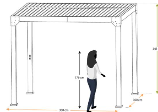
La pérgola de exterior “Somerset 3x3” es un cenador automatizado fabricado con una aleación de aluminio. Sus lamas ajustables permiten un control preciso de la luz solar y la ventilación, se pueden cerrar completamente para proteger este espacio contra la lluvia, la nieve, el viento y el sol intenso en época estival. El ajuste de las lamas se realiza a través de un sistema de control automático.
